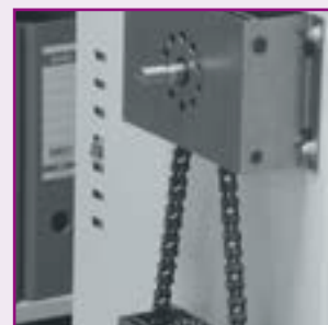
Solidny mechanizm korbowy – duże przełożenie, łatwość przesuwu.
